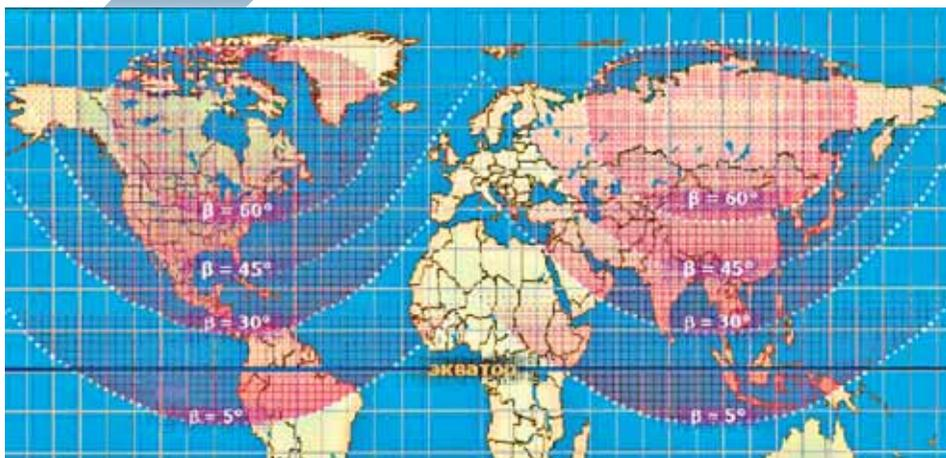
Рис. 2. Зона обслуживания КА на орбите типа «Молния»
