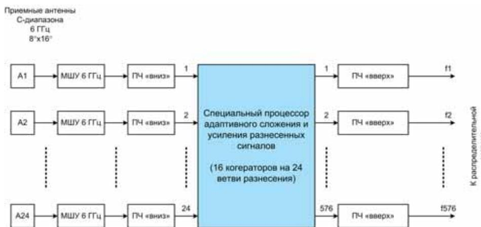
**Рис. 4.** Структурная схема приемного комплекса С-диапазона
