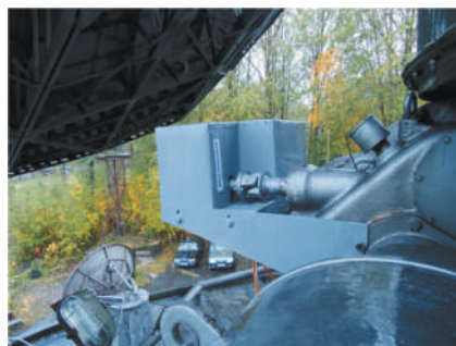
Блок БУА 3700 в составе аппаратной стойки земной станции, г. Архангельск
