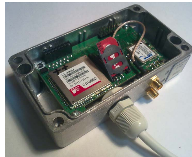
Рисунок 6 – Вставка SIM-карты в держатель
