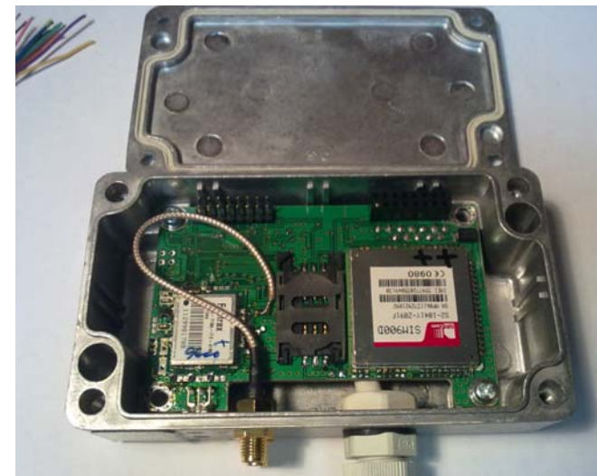
Рисунок 5 – Контроллер со снятой верхней крышкой (без SIM-карты)
