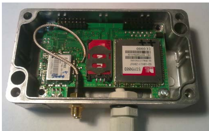
Рисунок 7 – Контроллер с установленной SIM-картой
