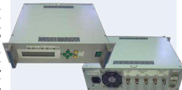
Блок обработки сигналов моноимпульсной системы наведения
