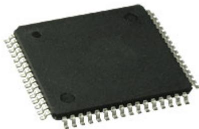
Рисунок 1.8 – Внешний вид микроконтроллера ATmega128L
