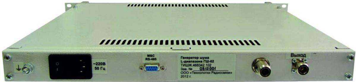
Рисунок 1.2 – Внешний блока генератора шума ГШ-02 со стороны задней панели
